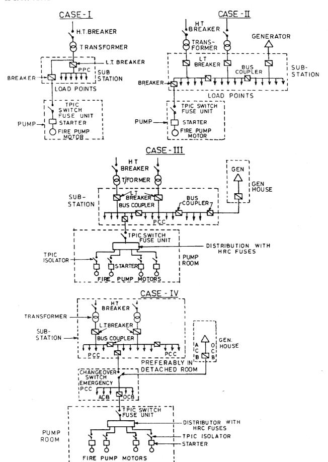
FIG. 14 FIRE PUMP CIRCUIT
